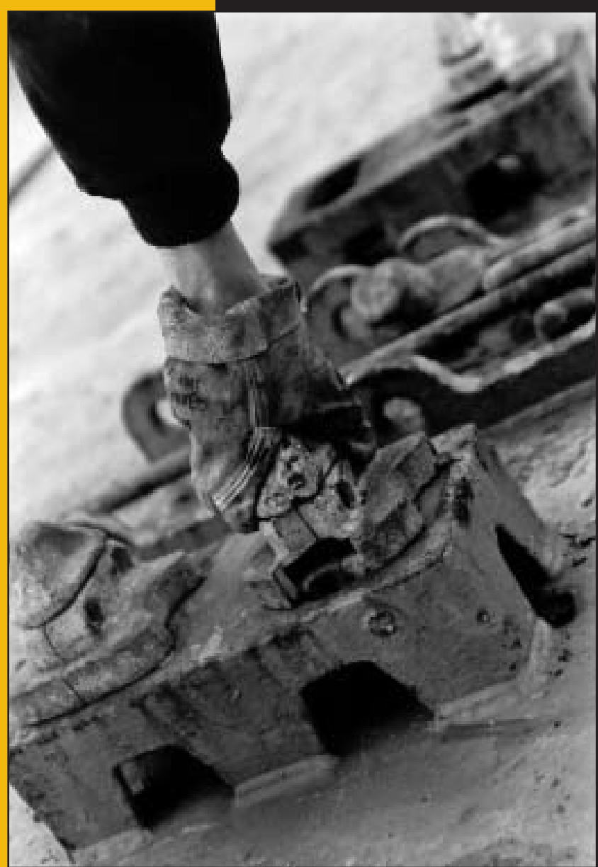
Pose d'un twist-lock, coll. Bazin.
