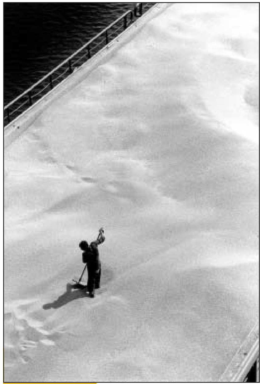
Terminal agro-alimentaire : étalement du blé pour éviter les surépaisseurs et permettre l'étanchéité du panneau de cale.
