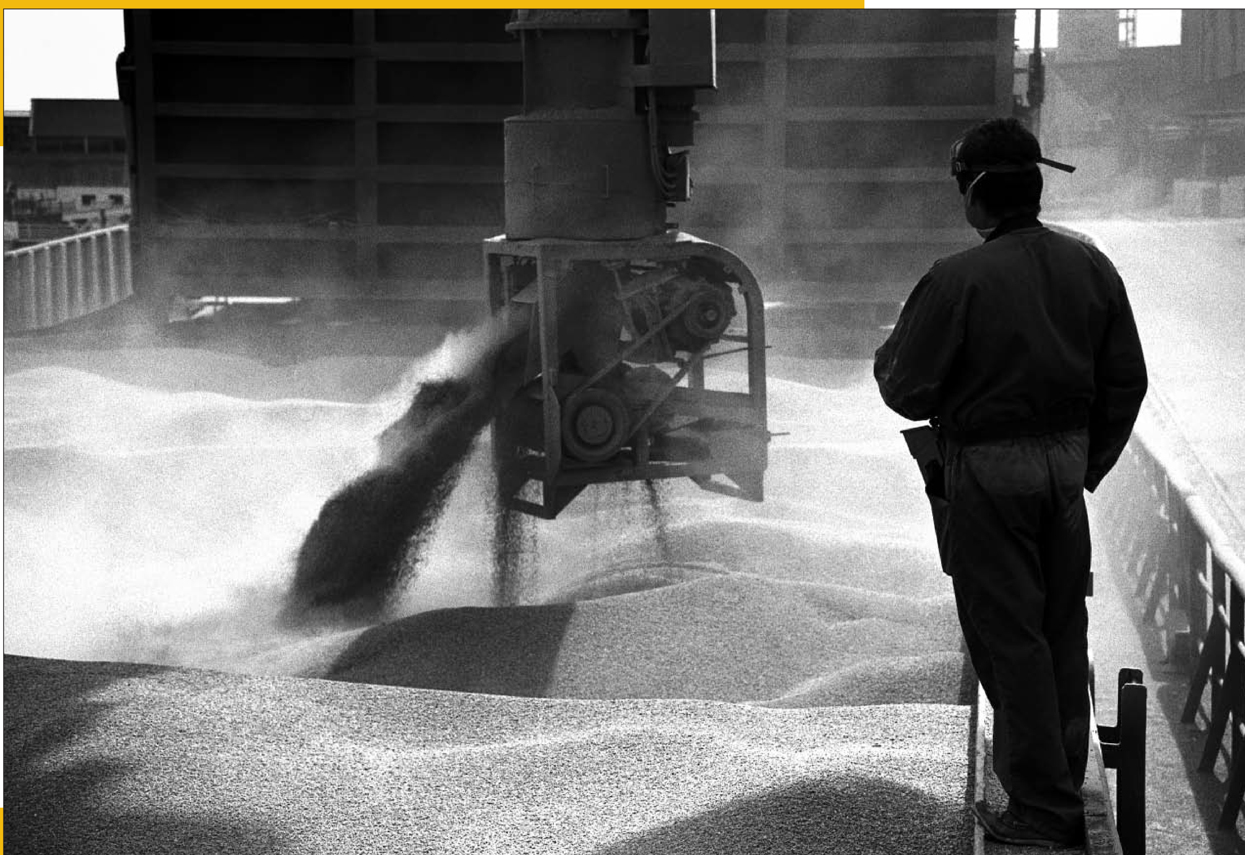
Saint-Nazaire, chargement de blé avec un « arrimeur-projeteur », coll. Bazin.
